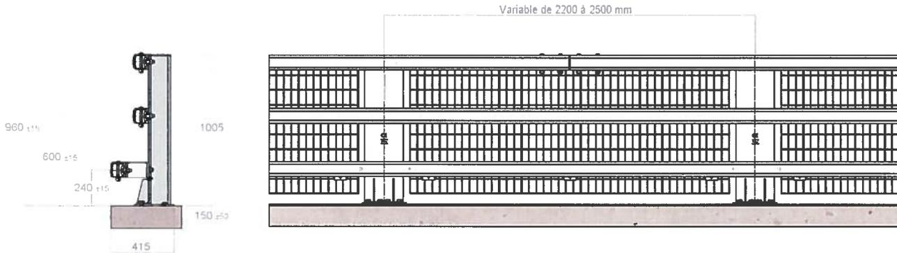
Barrière de pont en acier avec une distance entre les supports allant de 2,2 à 2,5 mètres (fixation sur ancrage type BN4 ou par chevillage chimique)
