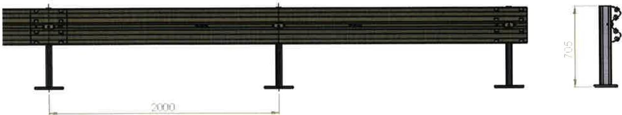
Glissière métallique simple file sur platine (supports tous les 2 mètres) à utiliser dans les zones de circulation
