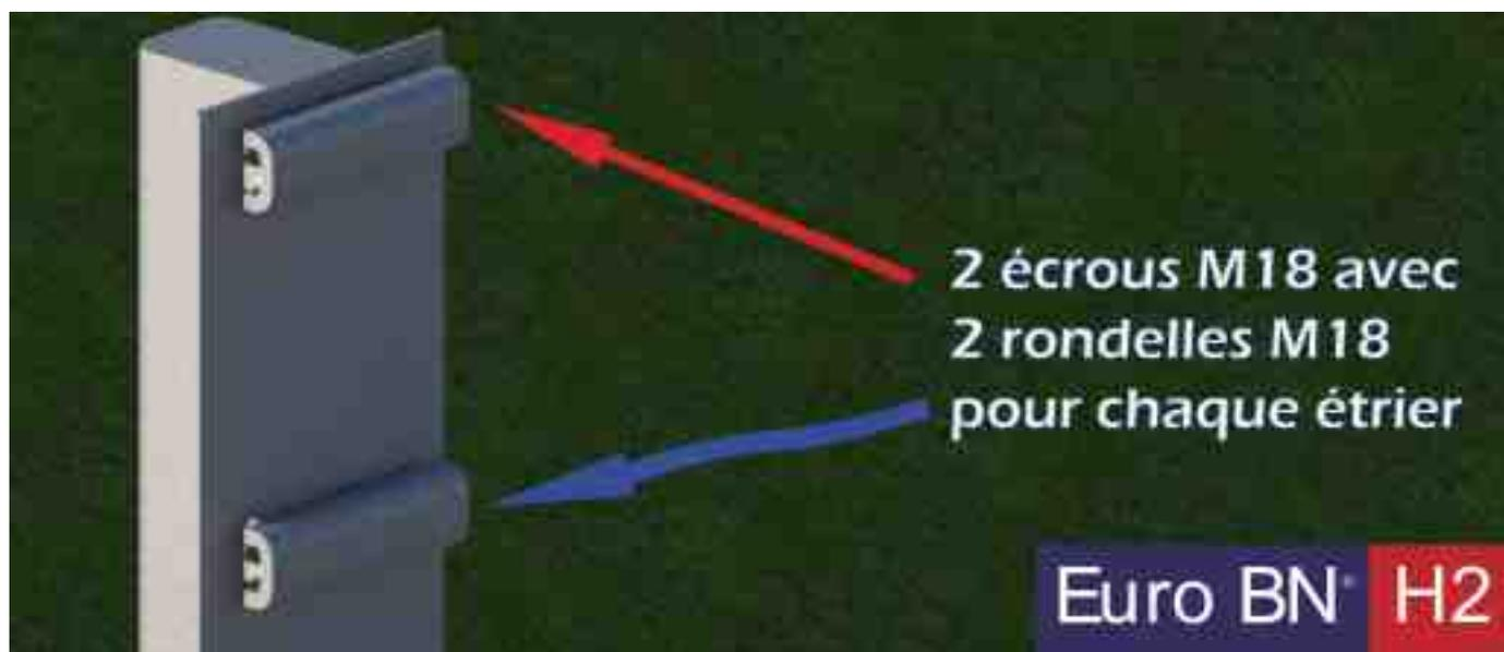
Sur chaque support, présenter un étrier avec goujon intégré LG 210 mm et visser «à la main» et en laissant libre l'étrier un écrou M18 avec une rondelle M18.
