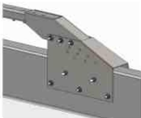
Au dos du GBA, installer 1 écrou M20 et une rondelle L20 sur chaque tige fileée.
