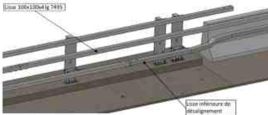
Les lisses et manchons sont assemblés avec des boulons TRCC 16x120 classe 5.8 + rondelles M16
