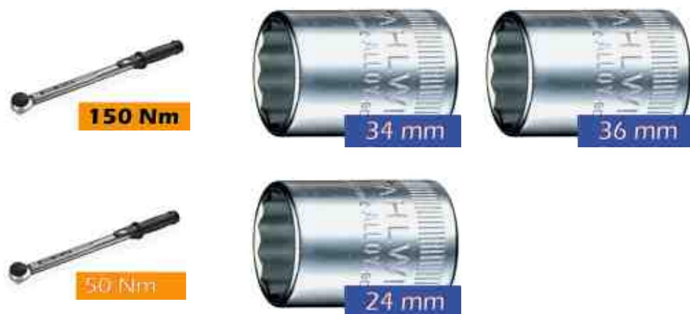
Le serrage des vis et boulons se fait en 2 temps: approche par un moyen de vissage mécanique (visseuse) réglée à 75% du couple final à appliquer et
