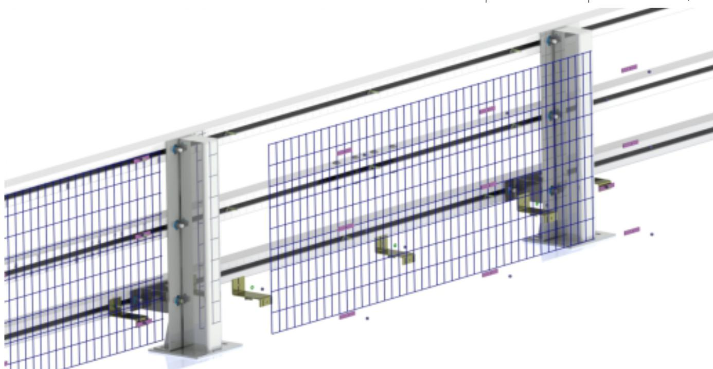
Le système EURO BN® H2-GC est un système réalisé entièrement en acier S235 JR protégé de la corrosion par galvanisation à chaud selon la norme EN 1461. Il se compose de supports, selon un entraxe variant de 2200 mm à 2500 mm et de 3 rangées de lisses identiques 100 x 100.
